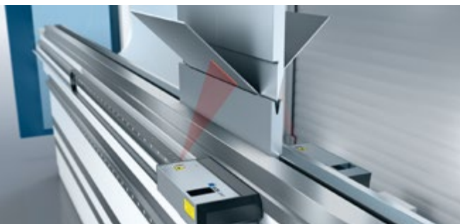
Präzise Winkel durch Lasermessung: ACB Laser.
