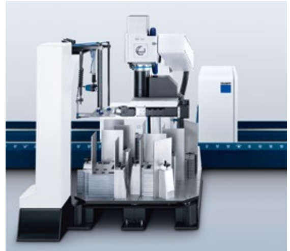
Blechentnahmestation mit Drehtisch
