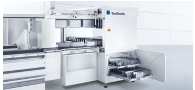
Der ToolShuttle rüstet Ihre Werkzeuge schnell und ergonomisch.
