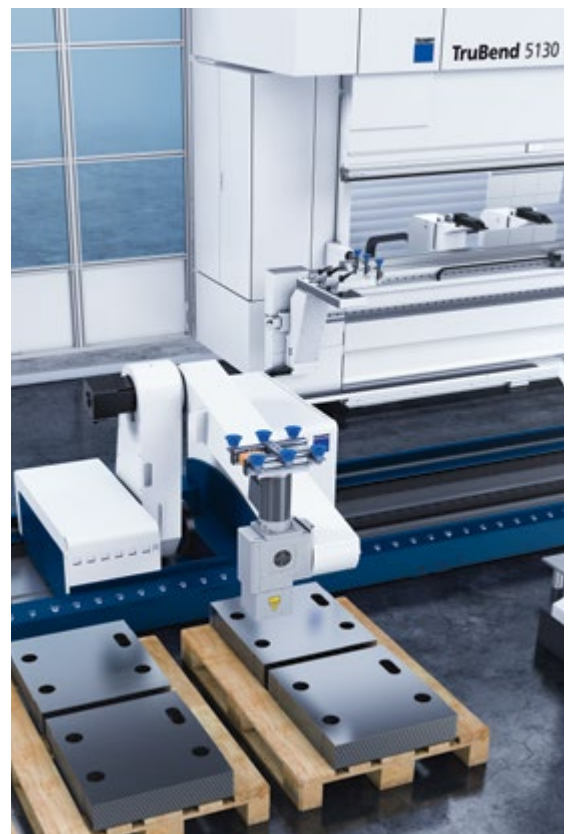
BendMaster (60) bei der Feinlageerkennung
