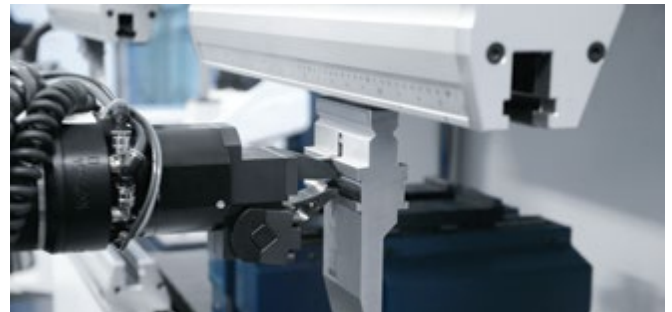
Das Werkzeug wird richtig aufgenommen und schnell positioniert.
